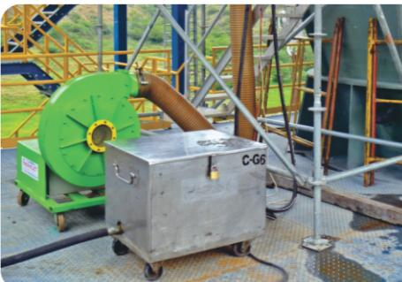
Los sistemas portátiles de quemadores convectivos de THERMOJET son diseñados y fabricados internamente, específicamente para actividades de tratamiento térmico de revestimiento refractario y alivio de tensiones en tanques y piezas metálicas.
